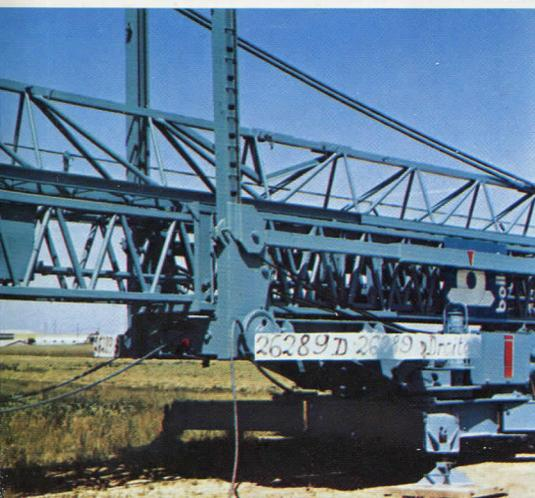
**5** Montage sans préparation spéciale du terrain, la flèche ne touchant jamais le sol. Déploiement en un mouvement continu. La grue étant toujours équilibrée quelle que soit sa position, est orientable en cours de montage et de démontage, ce qui permet d'éviter les obstacles.
