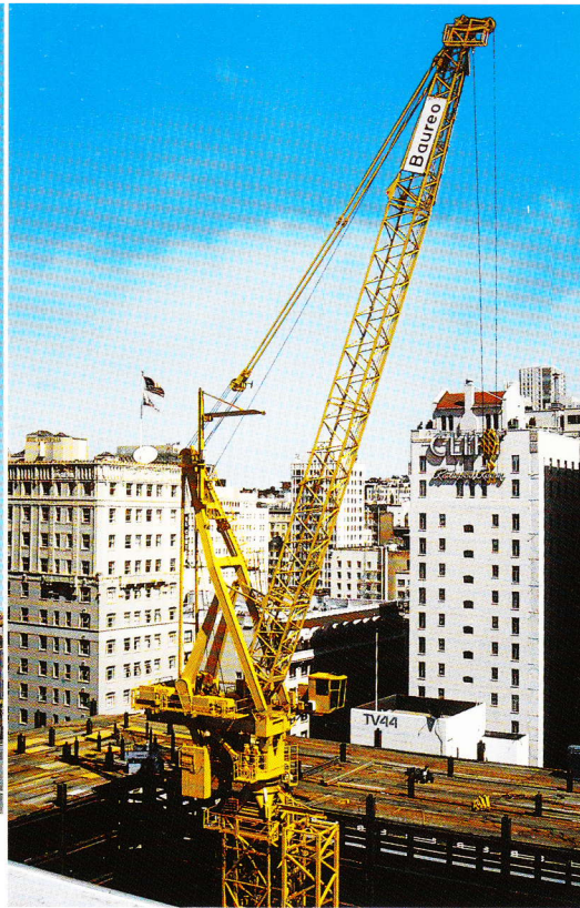
500 HC-L Baujahr 1985. Der erste HC-L kam zum Einsatz. HC-L-Krane sind für den Einsatz bei besonders hohen Gebäuden oder auf sehr engem Raum bestimmt.
