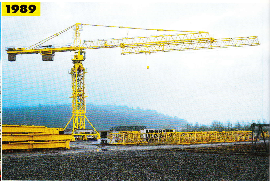
300 HC-T Baujahr 1989. Der Katzausleger-Kletterkran mit Teleskopausleger, mit einem fest- stehenden und einem verfahrbaren Ausleger, wurde vorgestellt.
