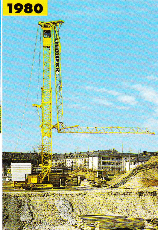
21 K Baujahr 1980. Liebherr-Schnelleinsatzkrane mit Ausleger-Luftmontage tragen zur weiteren Rationalisierung des Auf- stellvorganges bei.
