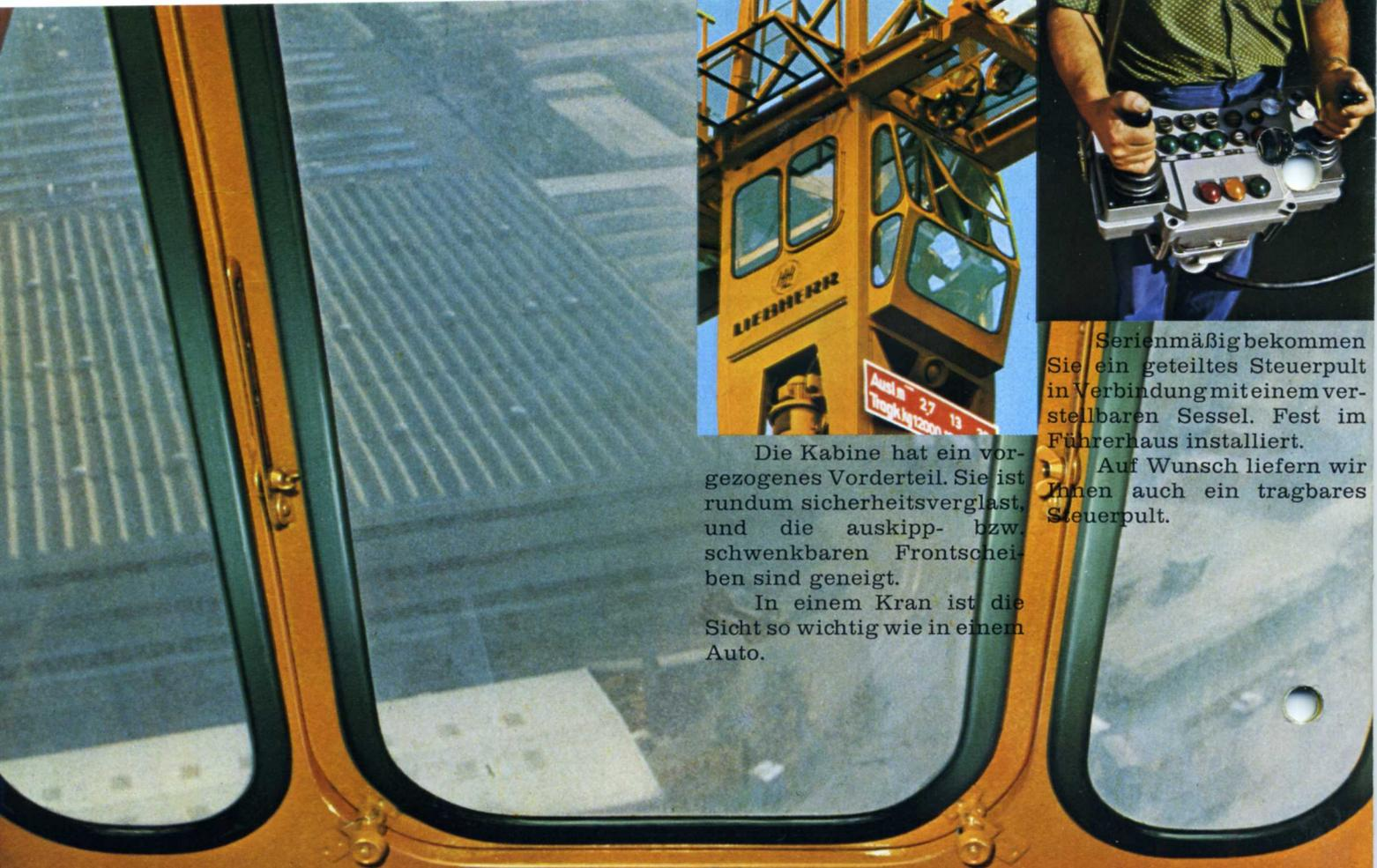
Die Kabine hat ein vorgezogenes Vorderteil. Sie ist rundum sicherheitsverglast, und die auskipp- bzw. schwenkbaren Frontscheiben sind geneigt.
