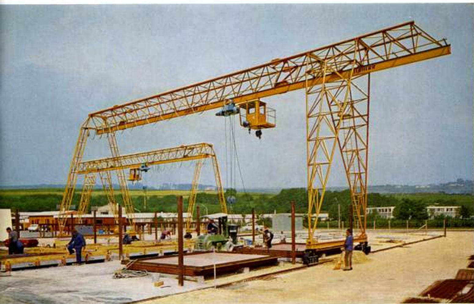
2 LIEBHERR-Bockkrane in einer Fabrik für Beton-Fertigteile
