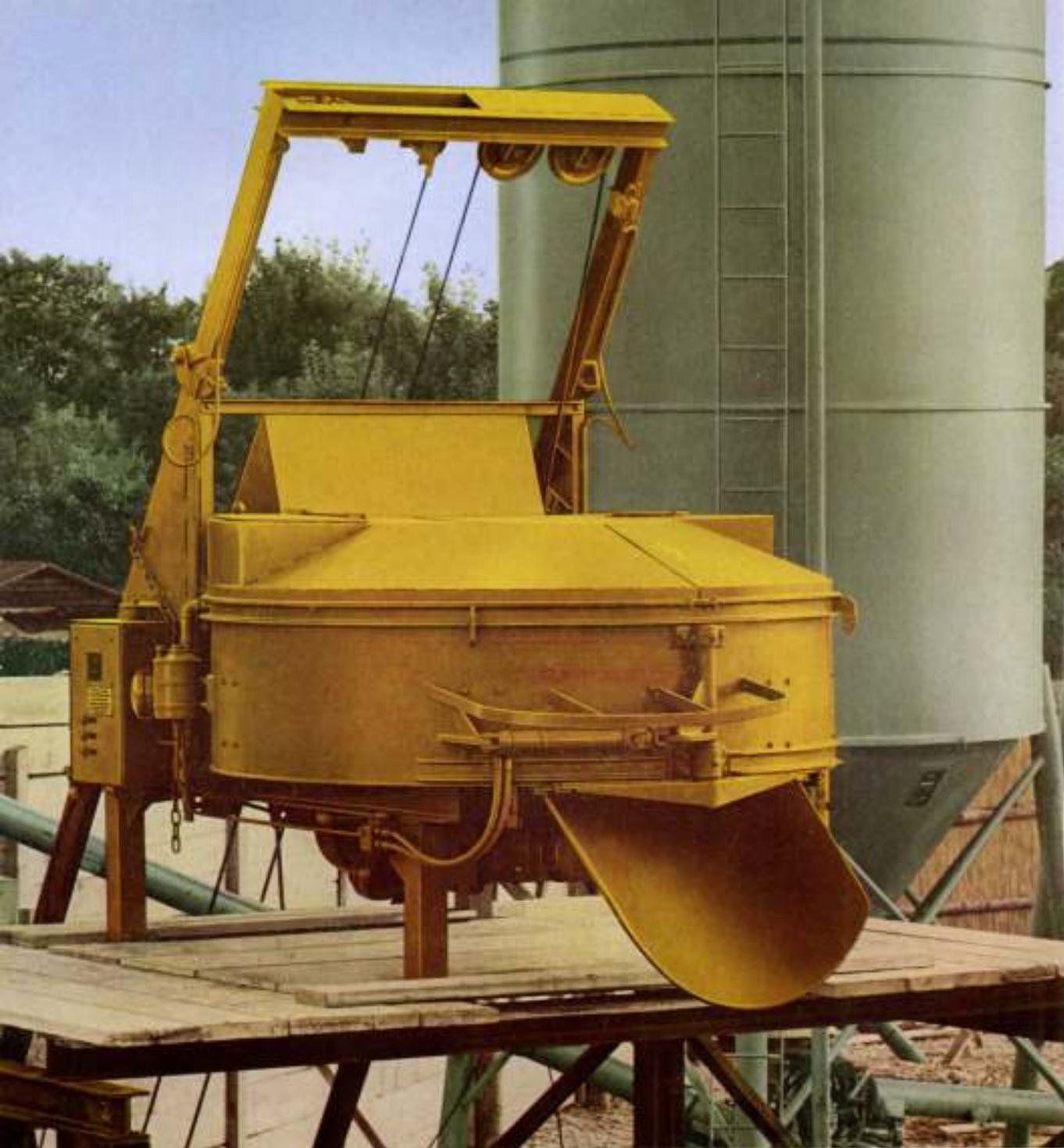
Der LIEBHERR-Hochleistungs-Zwangsmischer ist ein Schnelllauf-Tellermischer. Infolge der günstigen Umlaufgeschwindigkeit seiner Mischwerkzeuge wird ein intensiver Mischeffekt und eine ebenso ausgezeichnete wie hochwertige Betonqualität erreicht. Wir fertigen Zwangsmischer von 375 bis 1.500 l Fassungsvermögen.
