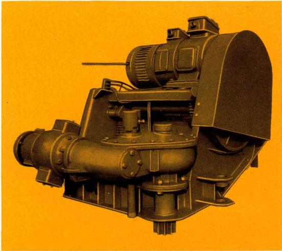
1 - TREUIL DE LEVAGE ET RÉDUCTEUR ORIENTATION
