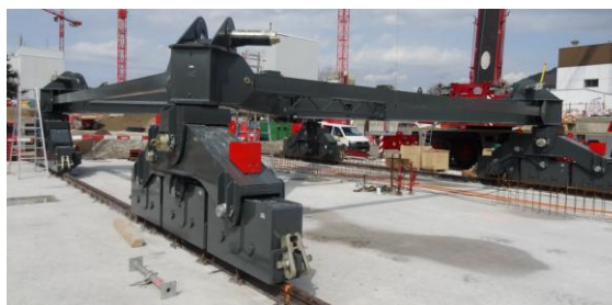
Montage der Fahrwerke und des Unterwagenkreuzes.
