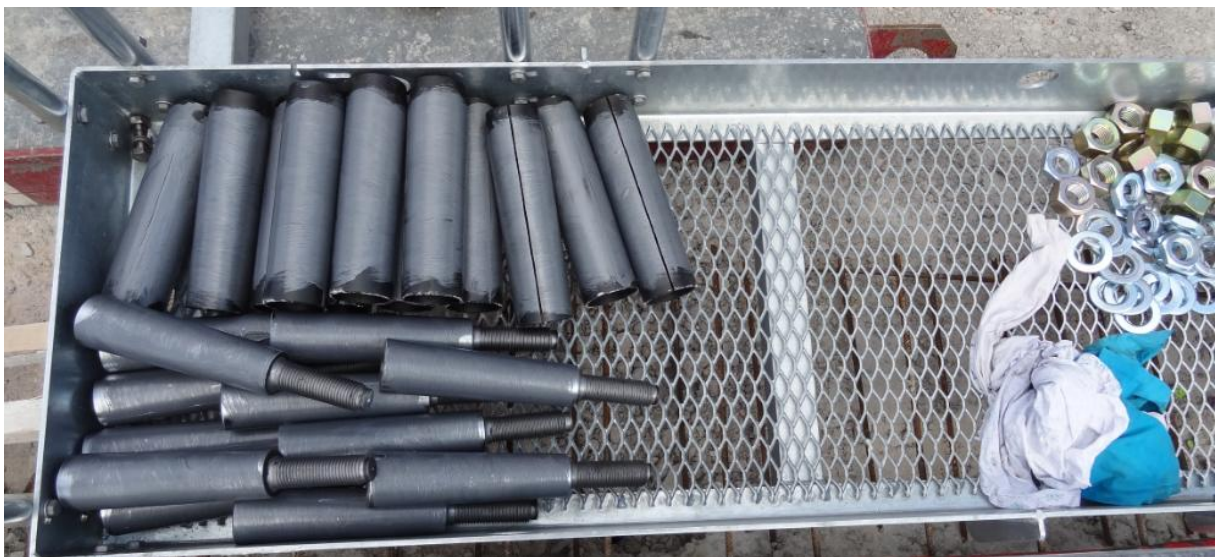
Turmverbindungsmaterial mit Konushülsen und Konusbolzen, ergibt eine spielfreie Verbindung.
