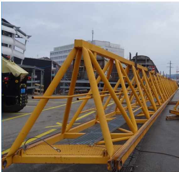
Zusammensetzen des Ausleger-Kopfteils (57m).
