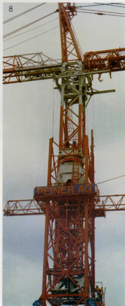
6. MK-Oberkran mit Klettereinrichtungen, Drehverbindung, Zahnstangen-Aufzug und Montagegalgen
