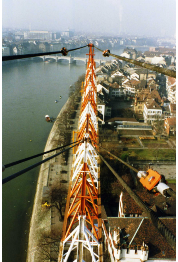
Blick auf den Gegenausleger mit Maschinenhaus, zwei Hubwinden und Ballastkörben sowie auf den Ausleger mit A Bock und den beiden gelben Seilstützen für das Hubseil. Fotos Rainer Schwarz
