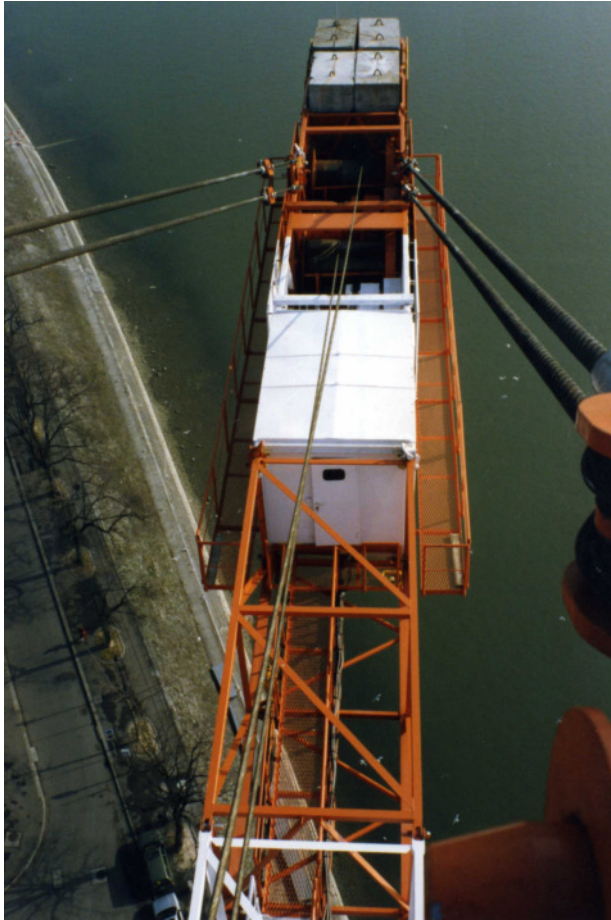
Blick auf den Gegenausleger mit Maschinenhaus, zwei Hubwinden und Ballastkörben sowie auf den Ausleger mit A Bock und den beiden gelben Seilstützen für das Hubseil. Fotos Rainer Schwarz
