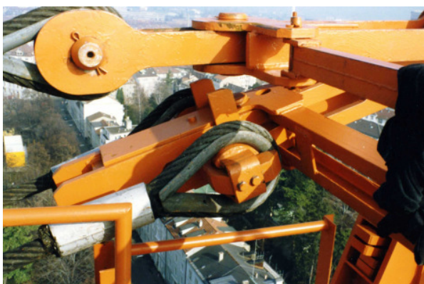
Hubwerksantrieb über je 2 Drehstromantriebe mit Gleichstromgeneratoren, welche die beiden Hubwerke hinten auf dem Gegenausleger bedienen. Das Hubseil hat keinen Festpunkt sondern beide Enden sind auf den Hubseiltrommeln befestigt. Fotos Rainer Schwarz
