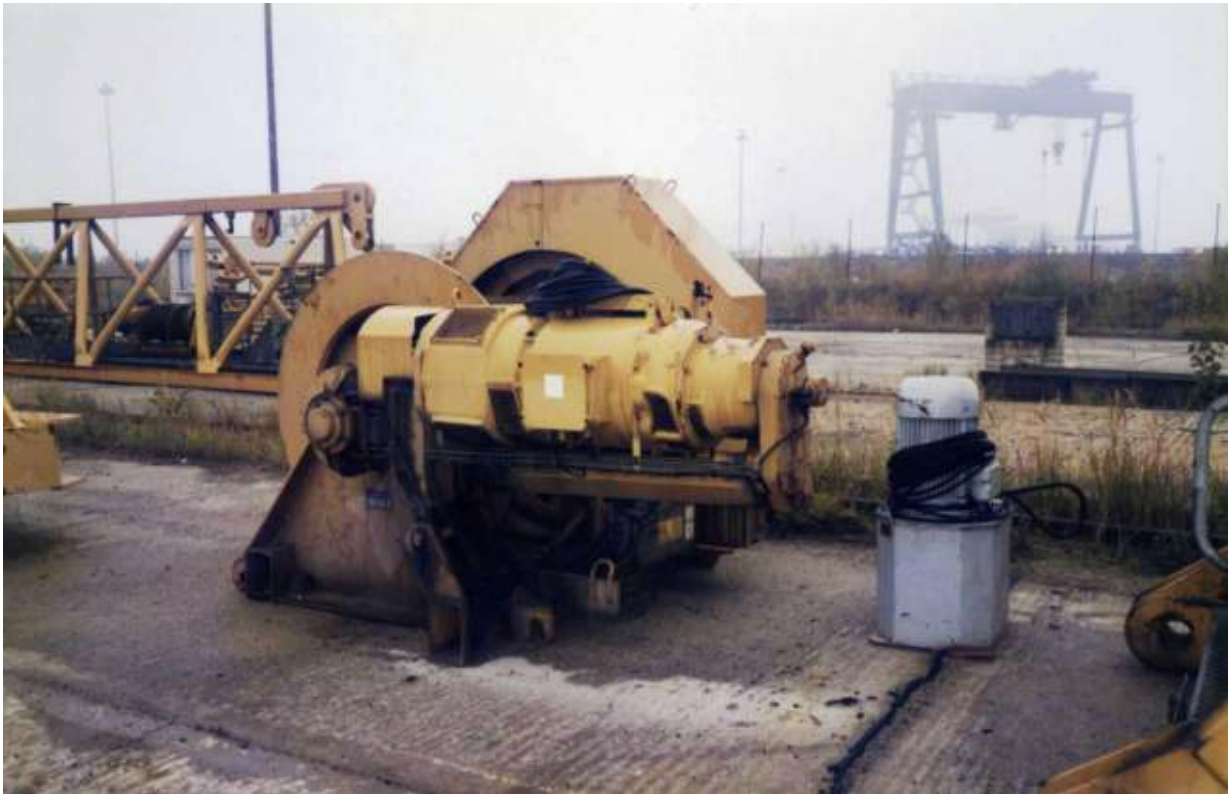
120 LMD 160 Hubwinde mit 88 kW Leistung
