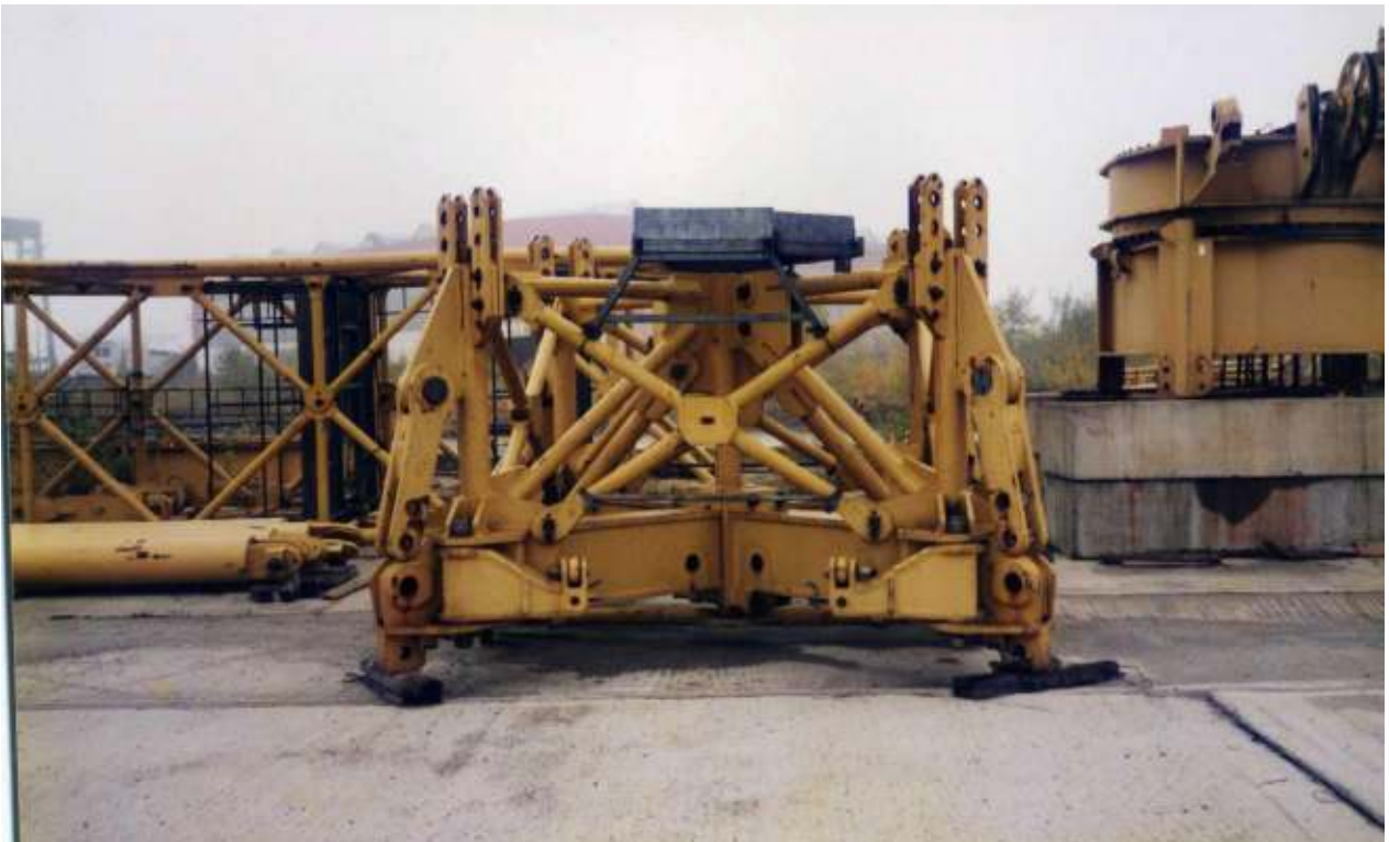
Übergangsstück zum Kletterturm
