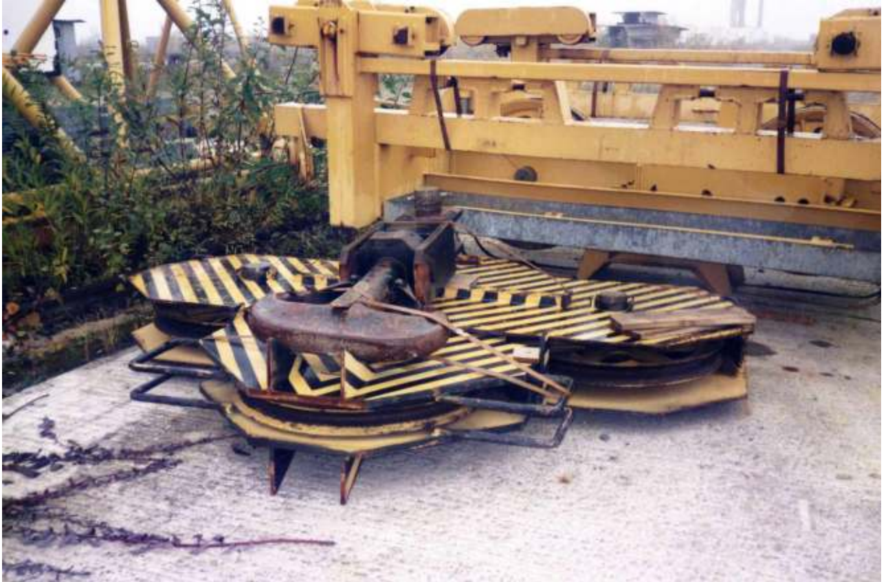
Unterflasche für 64 t Tragkraft
