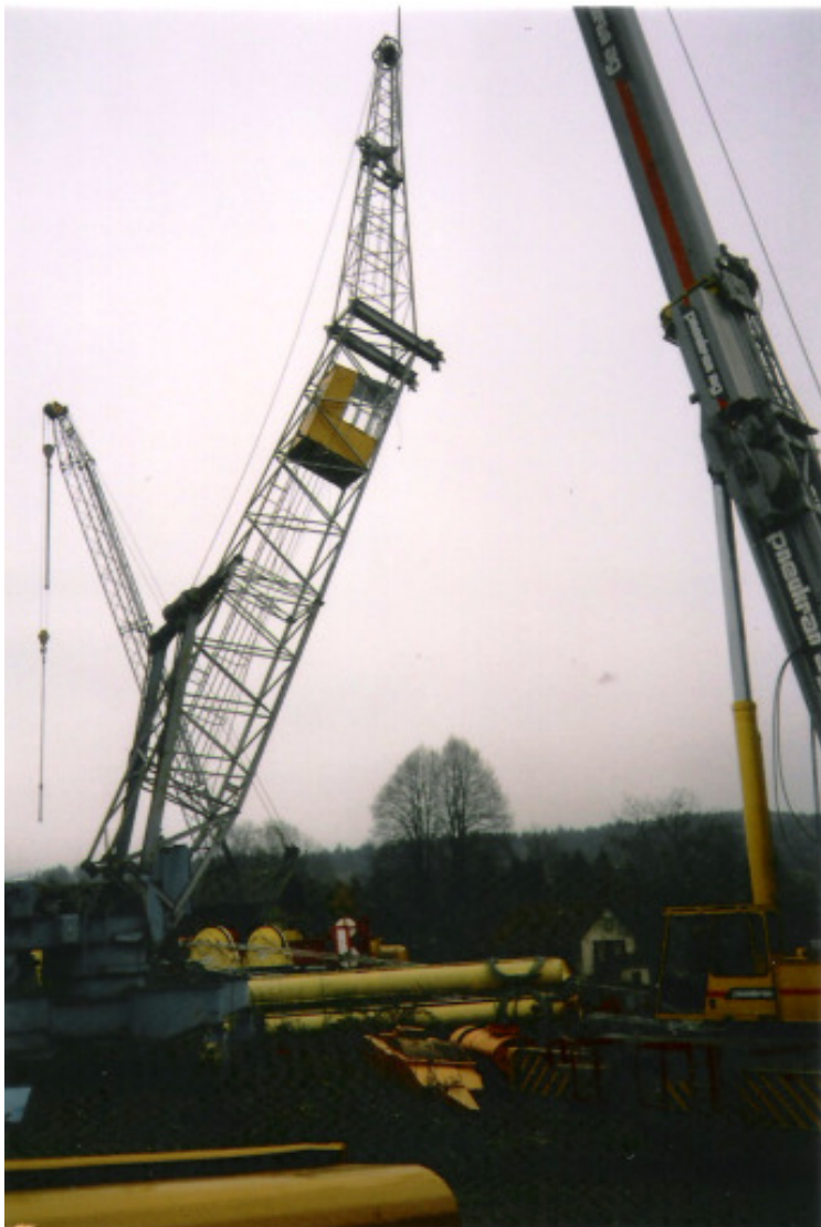
Demontage eine Peiner T Nadelauslegerkrans zur Entsorgung
