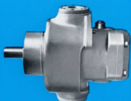
Bild 3 Selbstansaugende Flanscpumpe mit variablem Hubvolumen. Durch Schwenken des Zylinderblocks (linker Teil) vergrößert sich das Hubvolumen proportional zum eingestellten Winkel.
