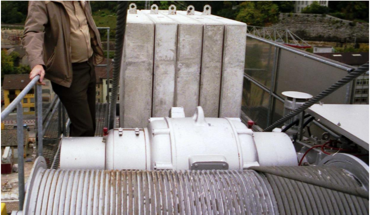
Das Hubwerk des TKF 1205 mit wichtigem 60 PS Landert Hubmotor, 3 Gang Hubgetriebe mit elektromagnetischen Kupplungen und hydraulisch gelüfteter Doppelbackenbremse
