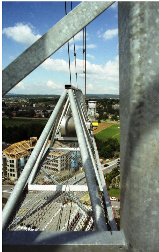
Katzfahrwerk an einem TKF 1205 mit stufenloser Altivar Steuerung von Telemecanique
