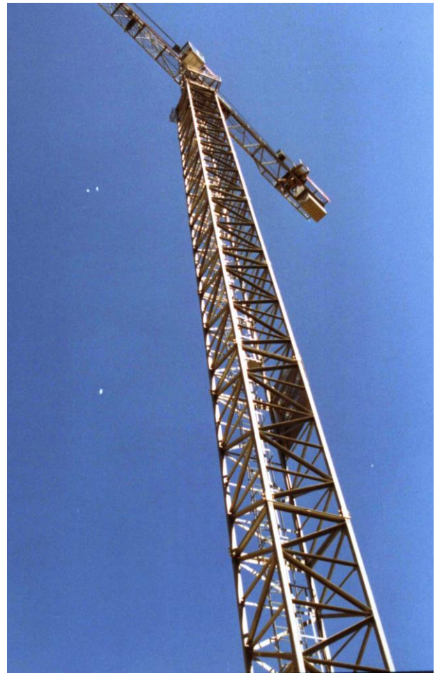
TKF 1205 mit 52 m Hakenhöhe in Schaffhausen, montiert auf stationärem Unterwagen
