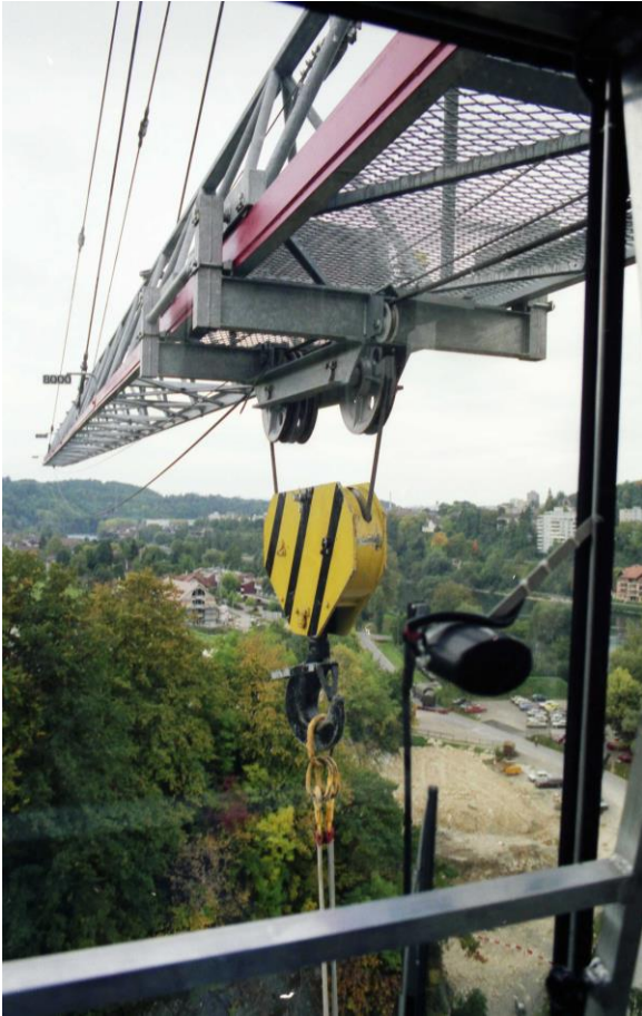
Laufkatze für 16 t Tragkraft, hier ohne Zwischenflasche eingesetzt, im Betrieb für eine max. Tragkraft von 8 t im zweisträngigen Betrieb der Unterflasche
