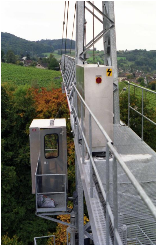
Kranführerkabine ausgeführt aus rostfreiem Material in V2A
