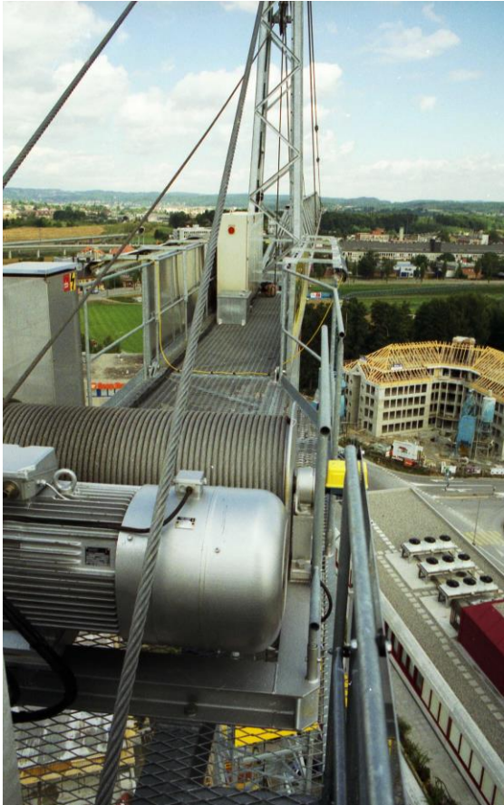
Hubwerk mit 60 PS Leistung, Fremdlüfter und stufenloser Statovar Steuerung
