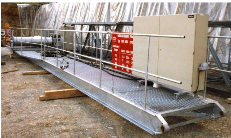
Normhubwerk mit 25 PS Leistung und Landert Hubmotor, 3 Gang Getriebe und Statovar Steuerung. Unter der Verkleidung sitzt die Doppelbackenbremse. Die Steuerung ist in einem aus rostfreiem Stahl gefertigtem Schrank untergebracht
