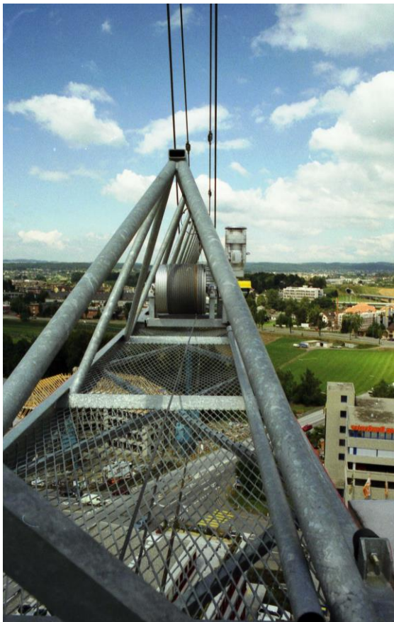
Katzfahrwerk an einem TKF 1205 mit stufenloser Altivar Steuerung von Telemecanique
