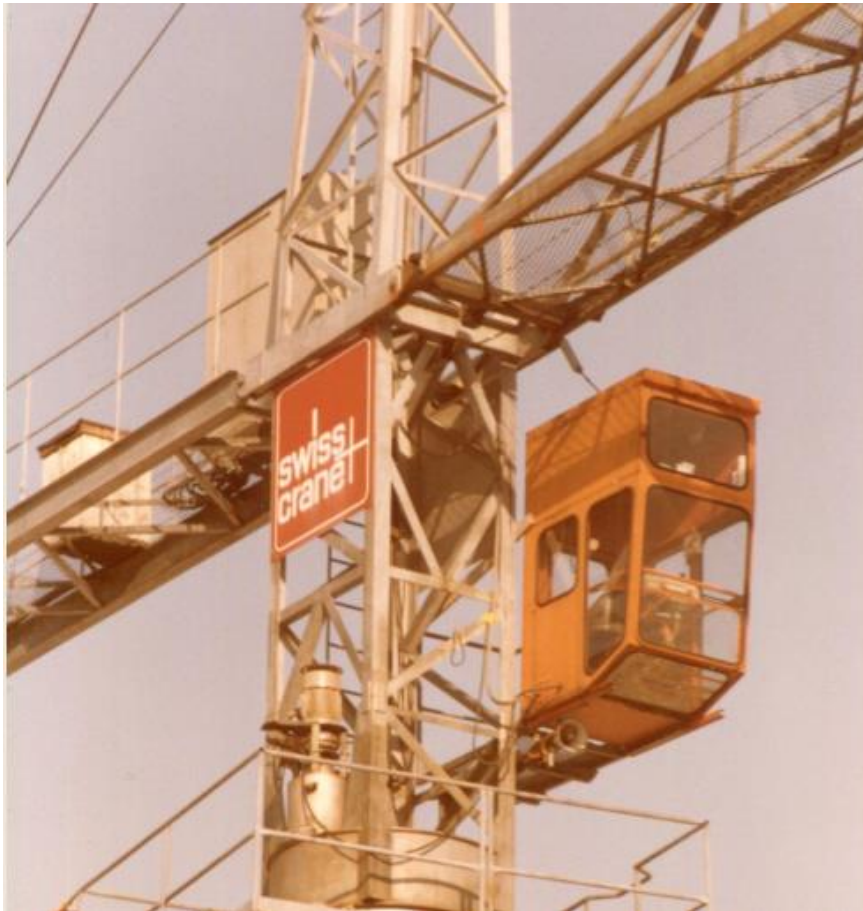
1971 – 1972, Engelking Aussenkabine mit Aufsatz, die Bedienung war im Sitzen und Stehen möglich
