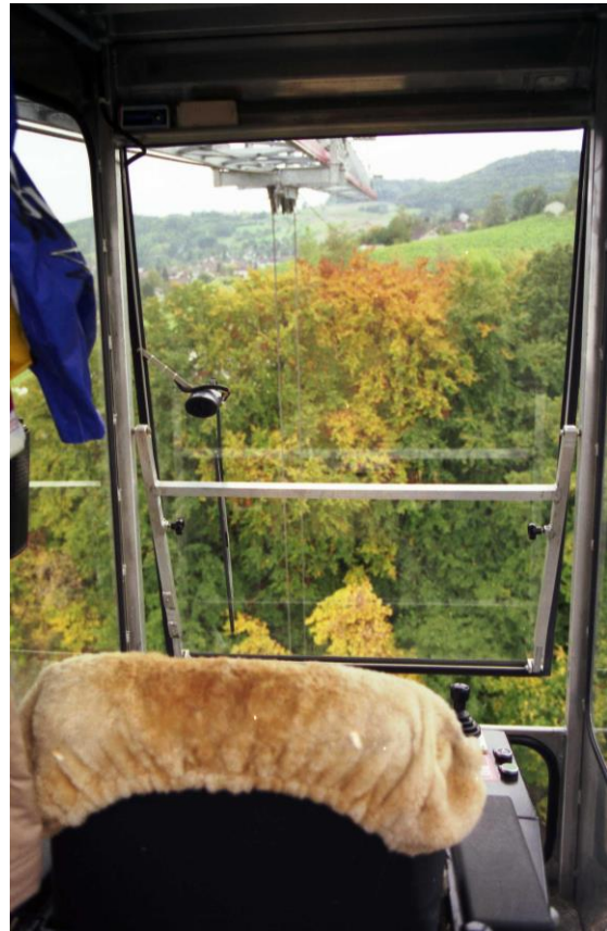
Kranführerkabine ausgeführt aus rostfreiem Material in V2A
