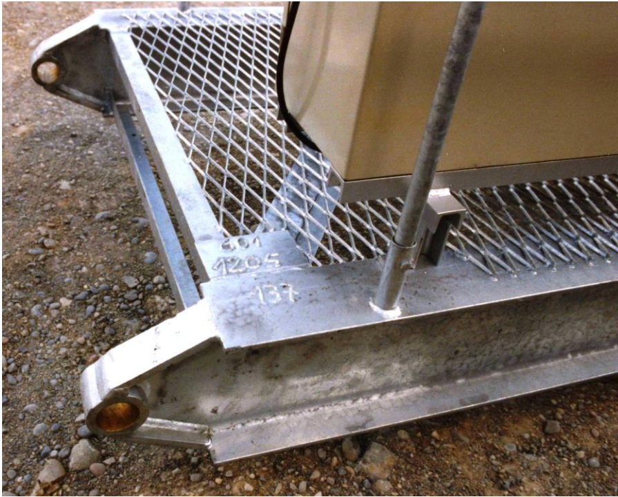
Einheitliche Gegenausleger der Krane TKF 601 bis TKF 1205
