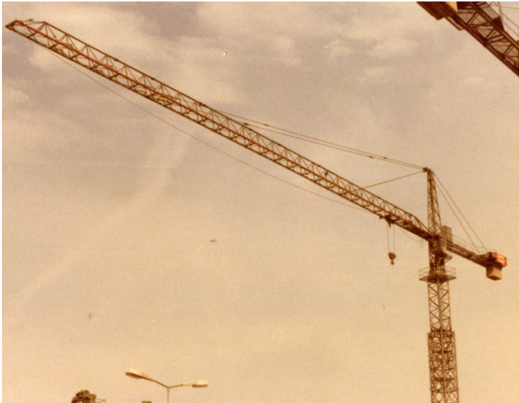
SWISS-CRANE TKF 1200 S mit 56 m max. Ausladung, ausgerüstet mit Kletterturm, 60 + 8 PS Hubwerk und vierfacher Hubseileinscherung für eine max. Tragkraft von 16 t
