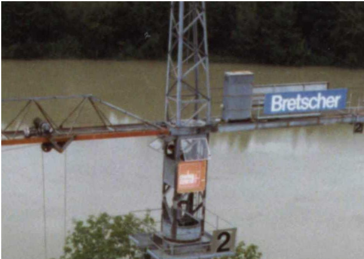
1967 – 1969, Tuminnenkabine, nur stehende Bedienung möglich
